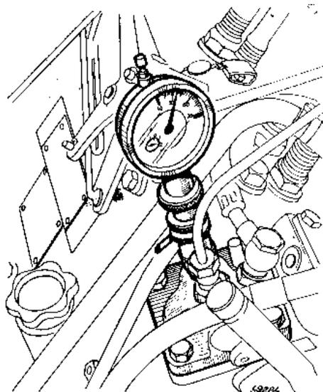
Purger la pompe par son raccord d'alimentation. Mettre la commande d'accélération à mi-course, **sans surcharge**. Démonter le raccord de refoulement du cylindre n° 1 (côté embrayage). Retirer le ressort et le clapet. Visser à fond l'**appareil de réglage Inj. 06, muni d'un comparateur**. Tourner le moteur, pour amener le piston de pompe au P.M.B. Mettre alors le comparateur à zéro.
