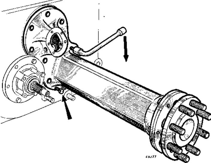
Retirer les vis de fixation de la trompette sur le carter.
