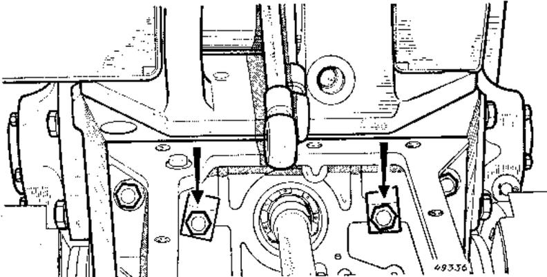
Retirer les deux vis d'assemblage boîte-pont placées dans le carter de boîte.
