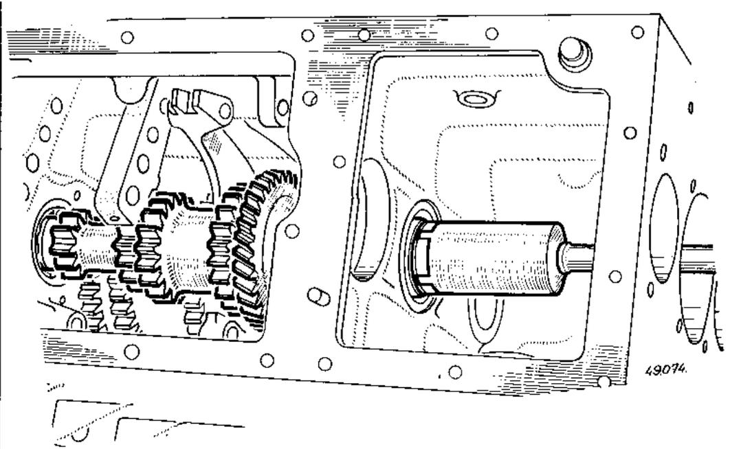
Déposer la bague d'arrêt du roulement arrière.
