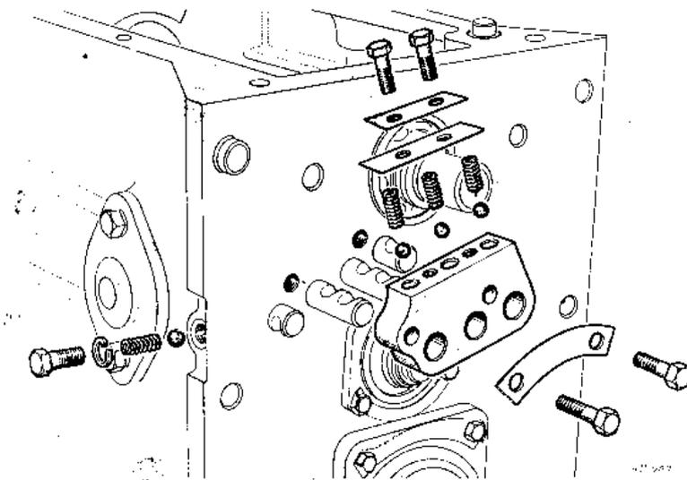
Déposer le verrouillage des axes de fourchettes.
