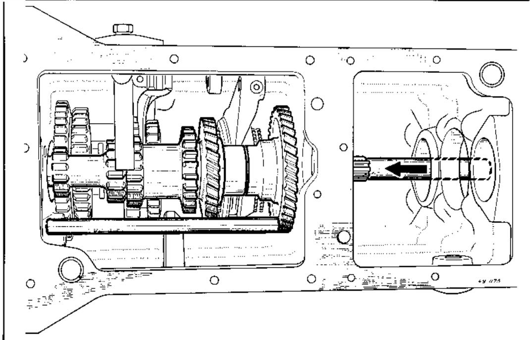
A ce stade, l'arbre ne peut continuer à reculer : le pignon de 2<sup>e</sup> ne se présente pas en face de l'alésage, gêné par le baladeur de 1<sup>er</sup>-2<sup>e</sup>. Reculer alors l'arbre secondaire de 1 cm environ. L'ensemble de cet arbre descend et permet le dégagement de l'arbre primaire.
