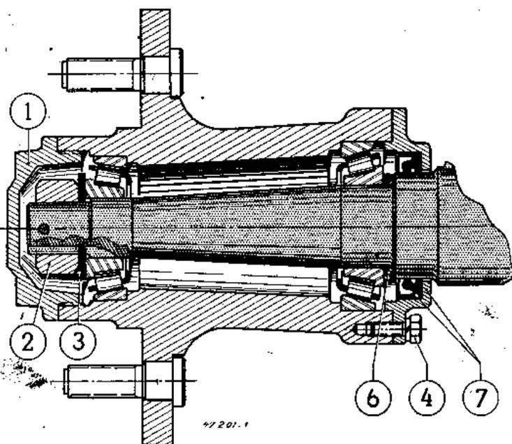
**NOTA.** — Avant de monter le moyeu, le remplir de graisse entre les deux roulements.
