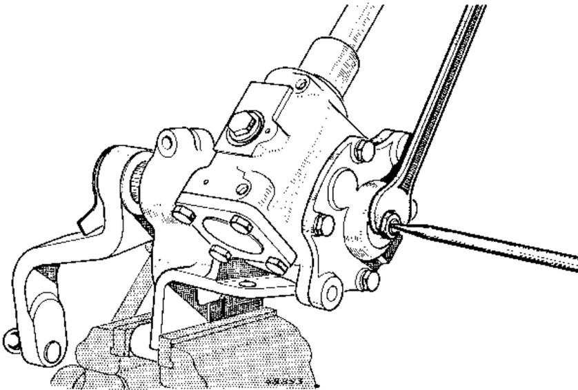
Pour un réglage correct de l'engrènement « vis globique - arbre porte-galet » la zone sans jeu (vérifiée au levier) se situe entre  $1/4$  et  $1/2$  tour à gauche et à droite du point milieu.
