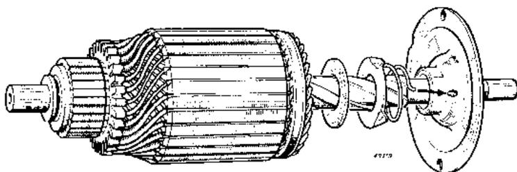
Enfiler sur l'ensemble roue libre-pignon les pièces dans l'ordre indiqué par la figure. Les enduire de graisse.
