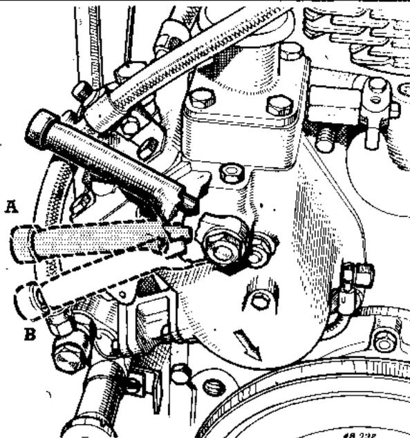
Régler les contre-écrous de la tige de façon que l'écrou inférieur vienne presque toucher la tige de commande de décompression. (Le poussoir doit reposer sur le dos de sa came, c'est-à-dire : position « soupape fermée »). Bloquer les contre-écrous. Amener ensuite la manette sur la position « décompression » (B). Dans cette position le bord de l'encoche de la tige de commande de décompression doit soulever la tige de culbuteur (Levée de soupape : 1 mm environ).
