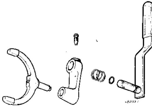
Déposer la commande du baladeur de démultiplicateur en retirant la vis d'assemblage fourchette levier.
