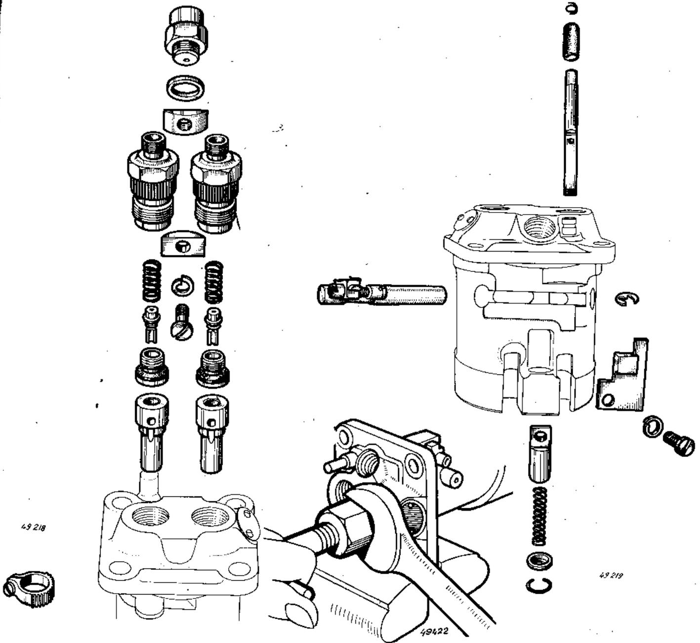
Débloquer la vis de maintien des demi-lunes arrêtoirs et les déposer.
