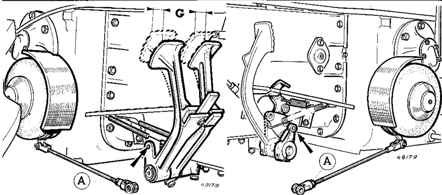
Débrancher les tiges de commande des leviers d'entraînement des cames.
