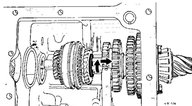
Tourner la rondelle pour faire coïncider ses cannelures avec celles de l'arbre et la dégager vers l'arrière.
