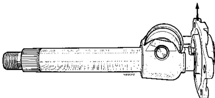
Séparer l'arbre « porte-galet » du couvercle, pour cela : débloquer le contre-écrou de la vis de réglage et visser à fond cette dernière pour dégager l'arbre porte-galet de l'alésage sur couvercle.
