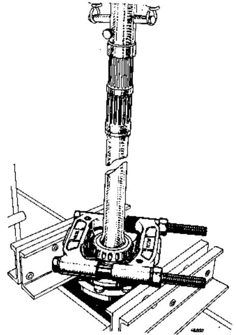
Extraire de la trompette les cuvettes des roulements intérieurs et extérieurs, avec l'extracteur **T. Ar. 24 A** et **T. Ar. 24 B**, en opérant comme suit :
