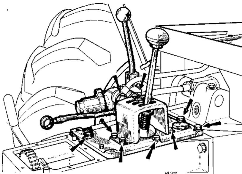
Déposer l'ensemble : distributeur de relevage — levier de commande des vitesses — couvercle arrière de boîte de vitesses.
