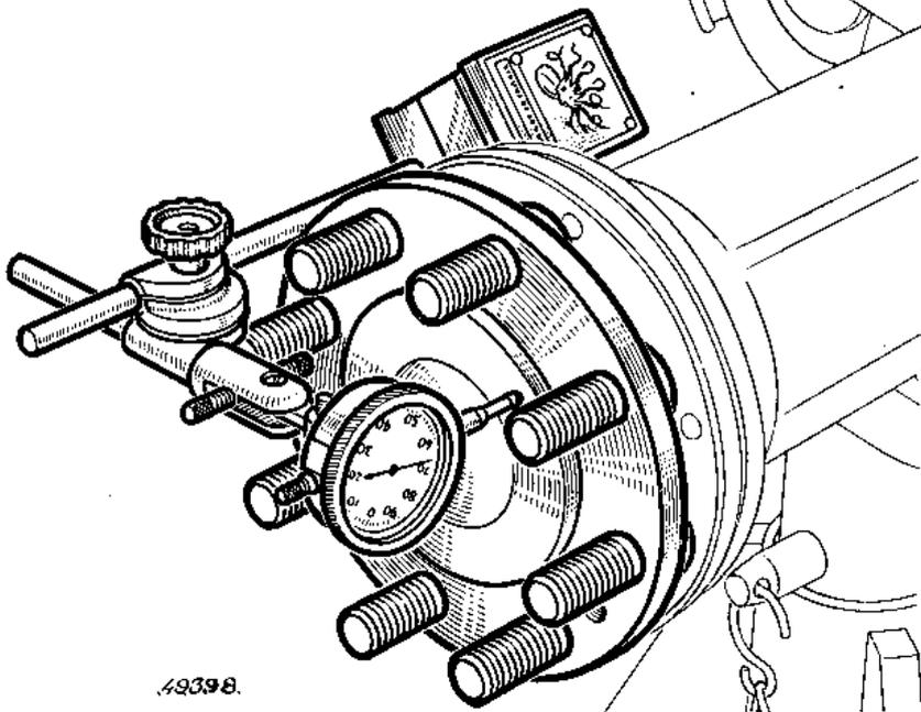
Vérifier le déplacement longitudinal de l'arbre au comparateur.
