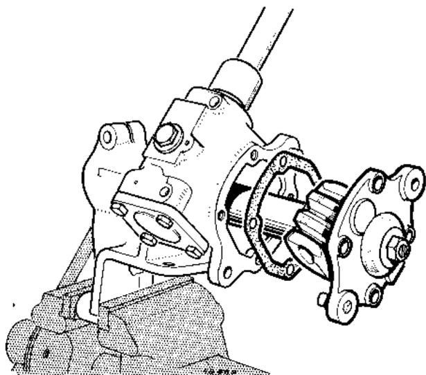
Dévisser les 4 vis de fixation du couvercle latéral et déposer l'ensemble « arbre porte-galet - couvercle latéral » (Pieds de centrage et joint en papier cartonné).
