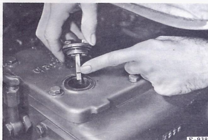
Fig. 34 A. — Jauge de niveau et orifice de remplissage du relevage hydraulique.
