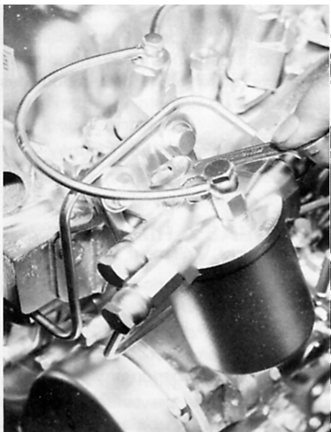
Fig. 16 — Vis de purge (1) sur filtre à gazole
